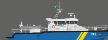
KBV 312-serien Längd: 26,5 m Bredd: 6,2 m Djupgående: 1,5 m Displacement: 53,8 ton Antal fartyg: 5
