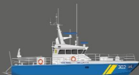
KBV 301-serien Längd: 20 m Bredd: 4,6 m Djupgående: 1,2 m Displacement: 35 ton Antal fartyg: 8
