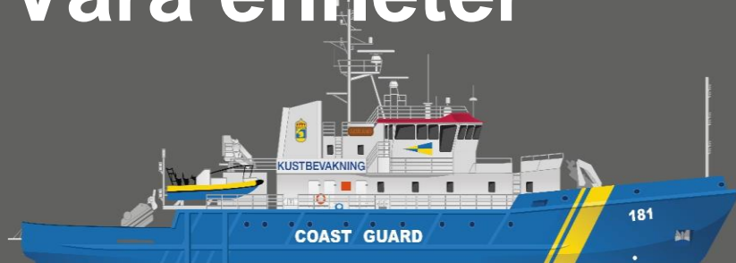
KBV 181 Längd: 56 m Bredd: 10,2 m Djupgående: 5,3 m Displacement: 991 ton Antal fartyg: 1
